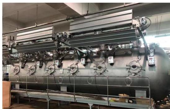
《UFH621 系列低水比高溫溢流染色機減控污水系統》的外觀
